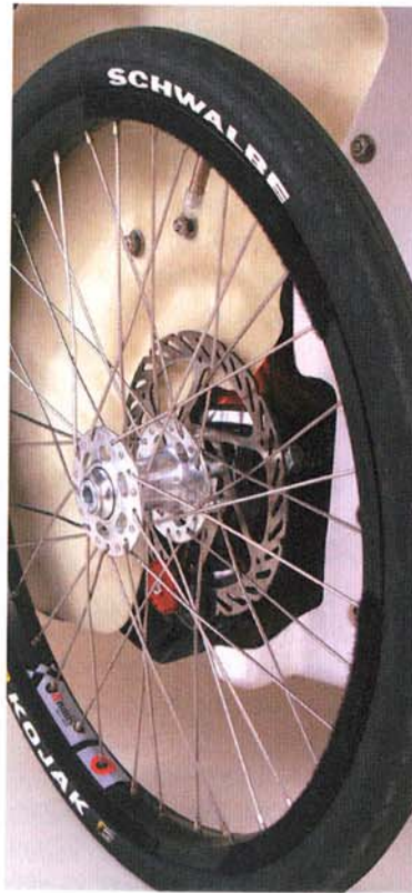
Unter der Radabdeckung steckt eine fein dosierbare und kraftvolle Avid BB7 Bremsanlage.
