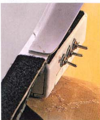
Die drei Hebel stehen für Warnblinkanlage, Abblend- und Aufblendlicht sowie Blinklicht.
