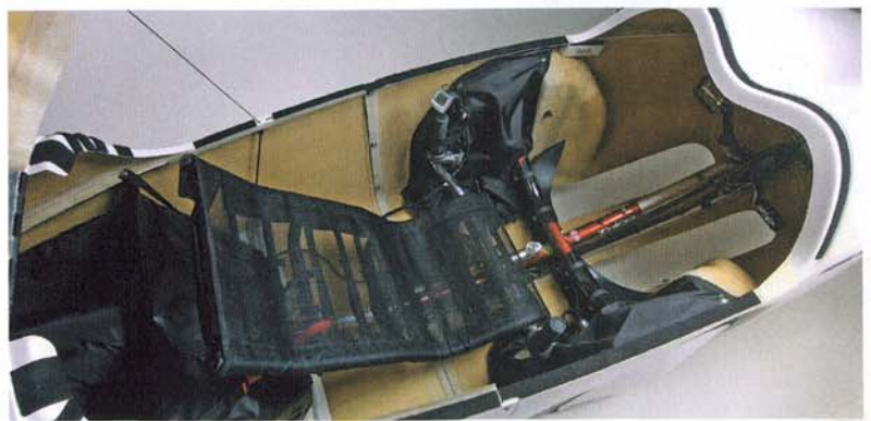
Die drei Hebel stehen für Warnblinkanlage, Abblend- und Aufblendlicht sowie Blinklicht.
