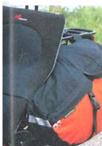
Über Sitz und Gepäckträger gehängte Gurte halten die Taschen am Rad.
