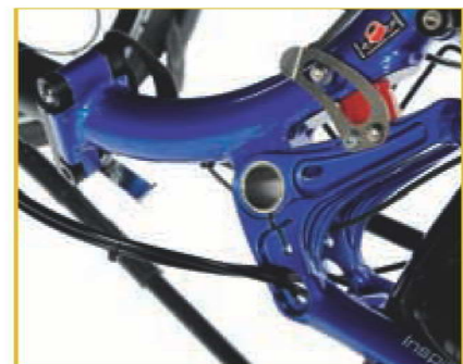
Stabiles Faltgelenk (hinten) und gedämpfte Hinterradaufhängung
