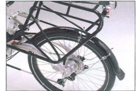
Top: Das hintere Schutzblech ist an der Schwinge angebracht und federt mit.
